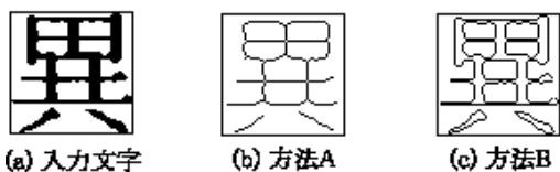
図1 中心線（方法A）と輪郭線（方法B）
