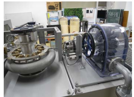
水力学実験装置(左:同計器 中央:同水槽および三角堰流量計 右:フランス水車とペルトン水車発電機)
