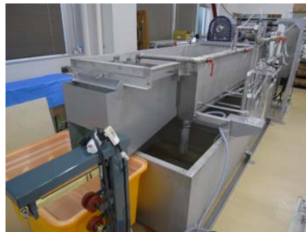
水力学実験装置(左:同計器 中央:同水槽および三角堰流量計 右:フランス水車とペルトン水車発電機)
