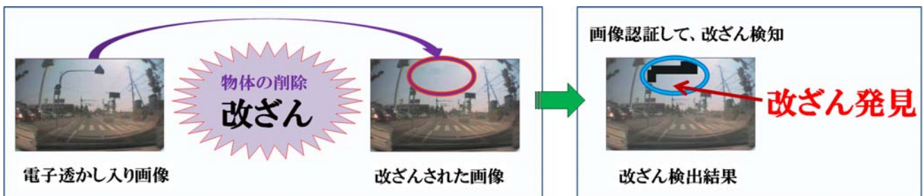
図1:透かし入り画像(左)、道路標識を削除して改ざんされた透かし入り画像(中央)、画像認証結果(右)
