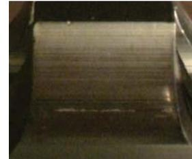
図2 高負荷トルクによる歯面損傷事例
