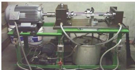
図1 FZG動力循環式歯車運転試験機
