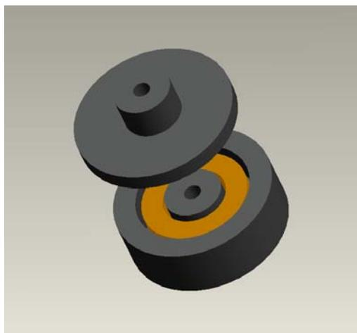
図1. 円筒電磁石の形状解析
