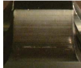
図2 高負荷トルクによる歯面損傷事例
