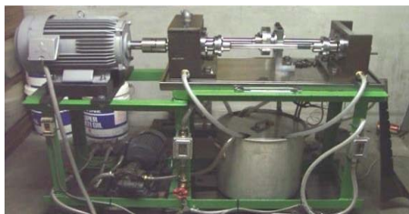
図1 FZG動力循環式歯車運転試験機
