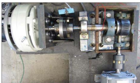
図3 動力吸収式ウォーム・ギヤ運転試験機
