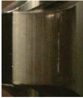
図2 高負荷トルクによる歯面損傷事例
