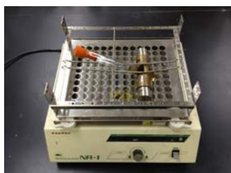
図2 ネオジウム磁石による磁場印加培養装置
