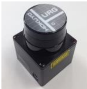
図 2 レーザ測域センサ URG-04LX-UG01
